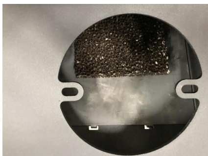
Katalysatormontage set fra røgstudsens over vermiculit røgvendepladen
