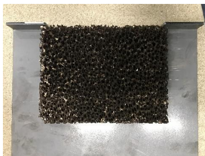
Katalysatormontage set fra røgstudsens over vermiculit røgvendepladen
