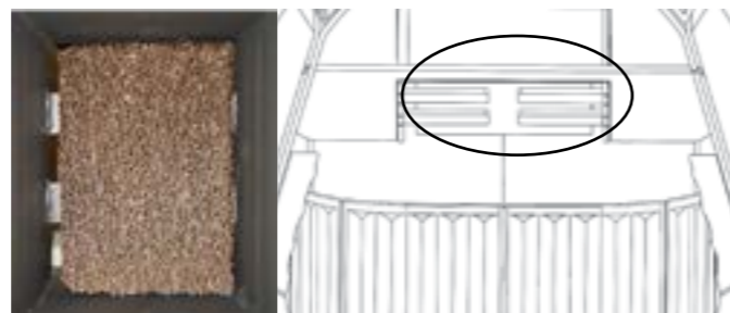
Katalysator placering set fra røgrørets udløb over vermiculite-røgvenderpladen
