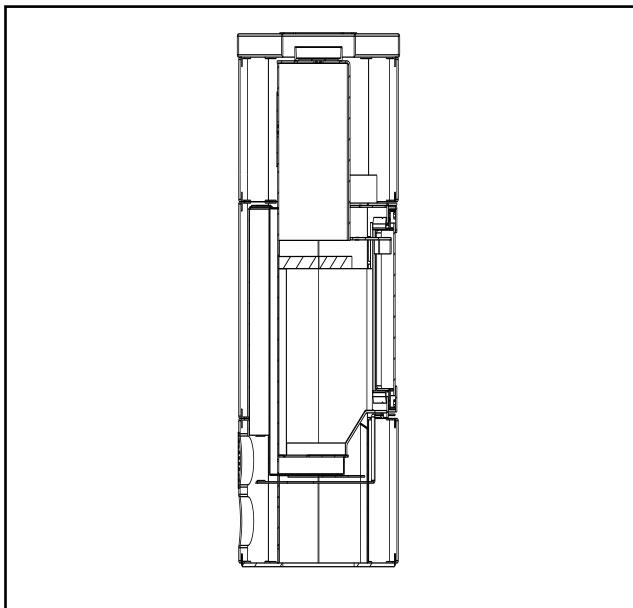
Røgvendepladen er todelt. Begge dele tages ud ved at løfte op i den ene side, hvorefter den kan komme fri i den anden side og tages ned i brændkamret og ud af lågen. Tilsvarende lægges de på plads ved at føre dem op på skrå i den ene side og derpå i den anden side og så lægges de på plads i midten og skubbes bagud.
