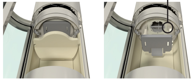
Røgchikanen ved at løfte den op og frem så den kommer fri af fikseringerne
