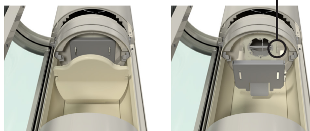
Røgchikanen ved at løfte den op og frem så den kommer fri af fikseringerne
