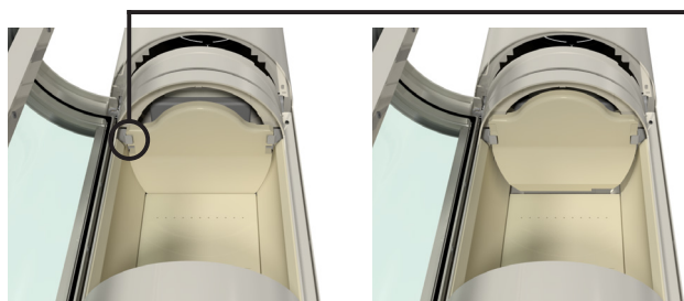
Fjern røgvenderpladen ved at trække frem og ned
