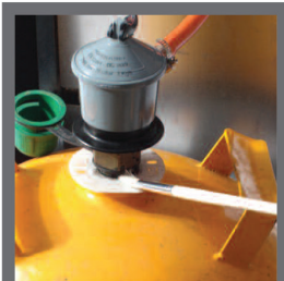
Regulator monteret på gasflasken
