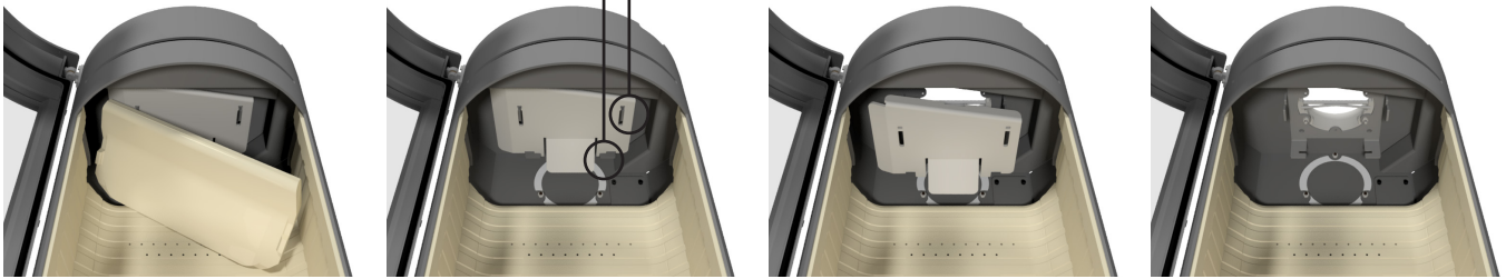
Fjern røgvenderpladen ved at løfte op og dreje sidelæns.
