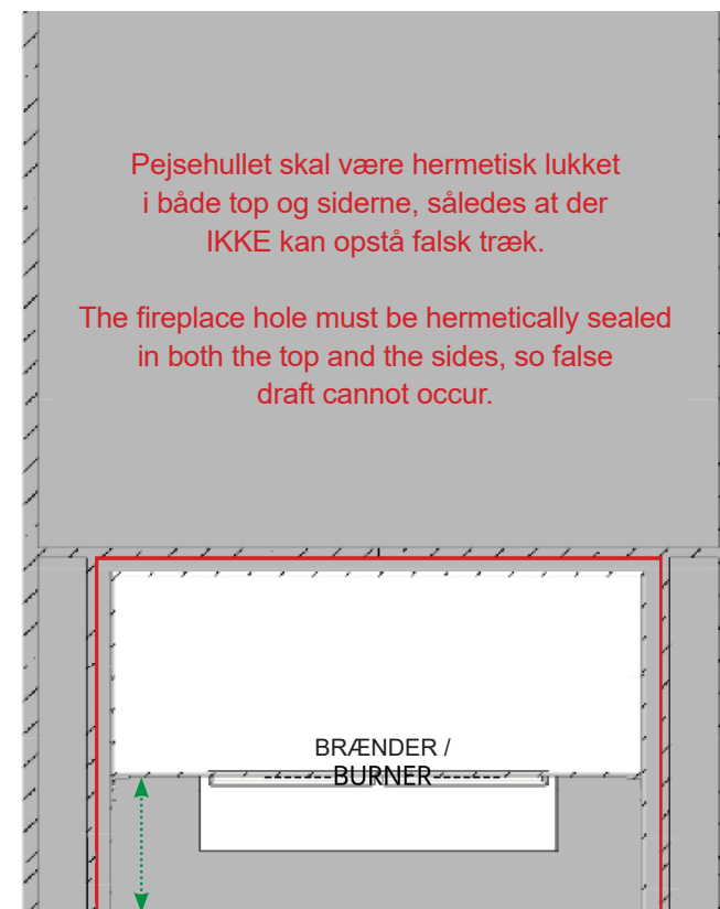
Væggen er ikke hermetisk lukket forneden, der kan komme træk / The wall is not hermetically sealed at the bottom, which can cause drafts.
